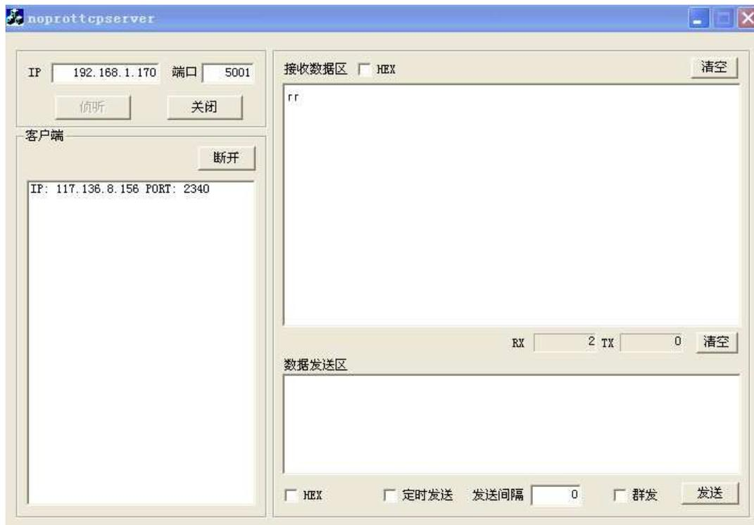
3、DTU 和数据中心建立连接后，就可以进行数据的无线传输。通过超级终端发数据给 DTU, DTU 收到数据后通过无线的方式发送给数据中心软件并显示。数据中心也可以发送数据给 DTU, DTU 收到后通过串口输出并在超级终端上显示。
