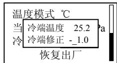
图 5-4 冷端修正（【系统】画面）
